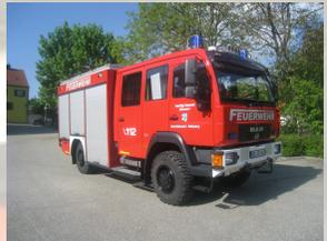
Das LF 10/6 ist ausgestattet mit einem 600 Liter Wasser- und einem 130 Liter Schaumtank; die eingebaute Pumpe fördert 1.000 Liter pro Minute;
