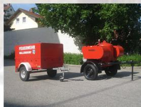
Der Pulverlöschanhänger P 250 verfügt über 250 kg Löschpulver, die bei Bränden, wie z. B. eines LKW benötigt werden.
