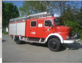
Das LF 16-TS ist ein Katastrophenschutz-Fahrzeug des Bundes; mit über 600 Metern B-Schlauchlänge und zwei Pumpen mit einer Förderleistung von 1.600 bzw.
