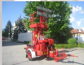
Die Polyma-Lichtgiraffe wird zur Ausleuchtung der Einsatzstelle benötigt; mit insgesamt 13.500 Watt Scheinwerferleistung wird die Nacht zum Tag;
