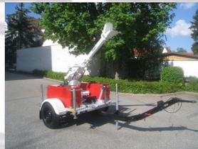
Der Wasserwerfer wird benötigt bei Bränden in großen und hohen Gebäuden; er kann 2.300 Liter Wasser pro Minute auf den Brandherd abgeben;
