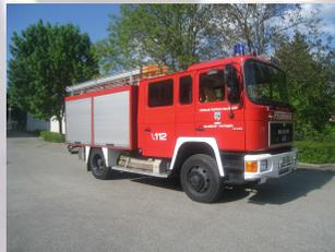
Das TLF 16/25 hat einen Wassertank von 2.500 Litern und eine Pumpe mit einer Förderleistung von 1.600 Litern pro Minute;
